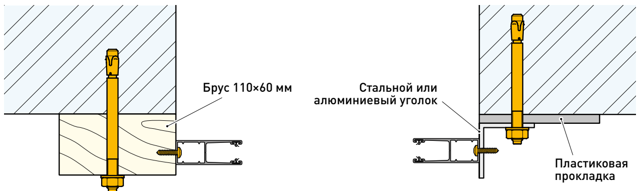
Рис. 15. Варианты крепления шин направляющих
