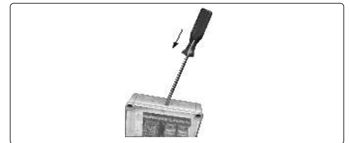
Рисунок 1. Выбивание отверстия для кабельного ввода
